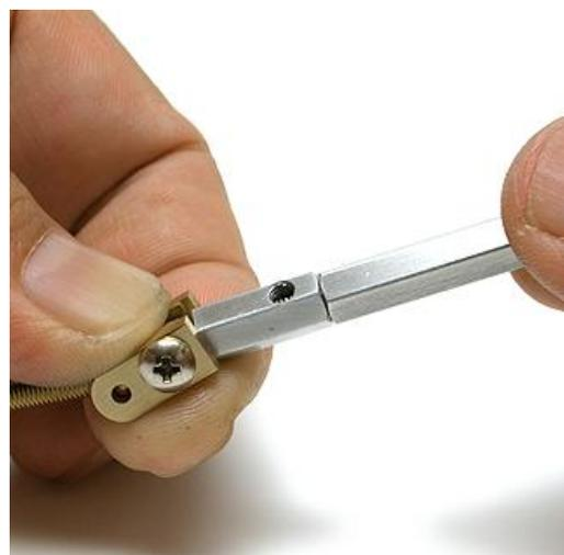
(3)しめねじをゆるめ、ねじおさえをブロックにねじこみ、再び、しめねじを軽めにしめて、プレート - ブロック間のがたつきをチェックします。
