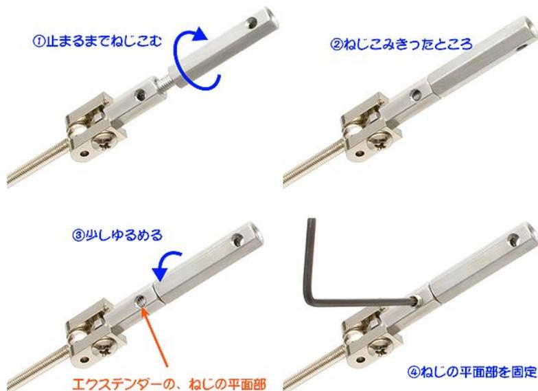
(2)シャフトとエクステンダーとの接続方法は、シャフトとブロックの場合と同じです。シャフトをエクステンダーにねじこみ、両側から、いもねじで固定してください。いもねじ先端は、シャフトの平面部に接触させます。シャフトのねじ山は破損しないでください。
